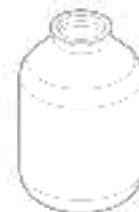
Мембрана гидроаккумулятора (стр. 178)
